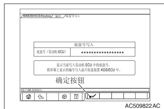
11. 显示写入到发动机 -ECU 中的底盘号后，按下 “OK” (确定) 按钮。
